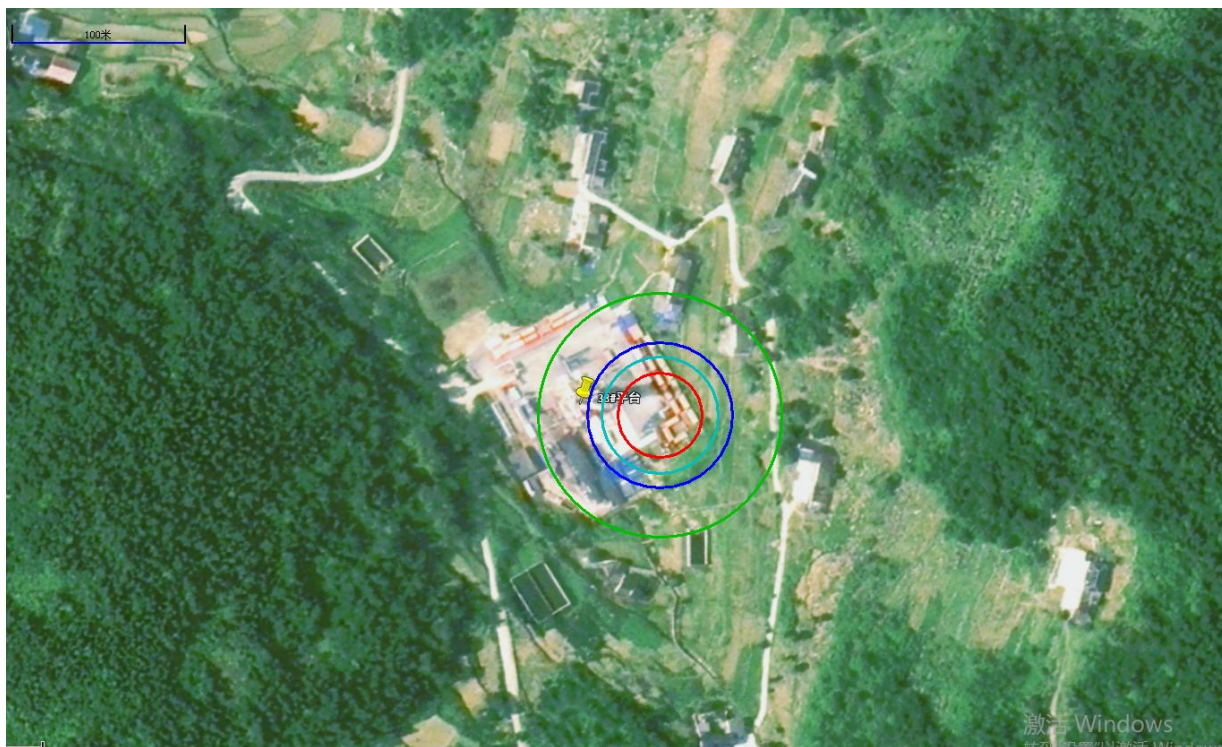
图 5.5-1 焦页 33 号平台生产分离器泄漏云爆后果图
